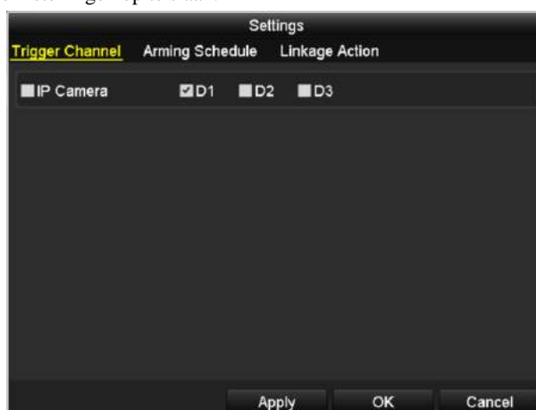
Figure 8. 2 Getriggerde camera's voor bewegingsdetectie instellen
