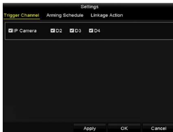
Figure 5. 17 Getriggerde camera's voor VCA-alarmen instellen
