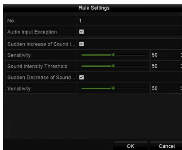
Figure 9. 10 Regels voor detectie van audio-uitzonderingen instellen
