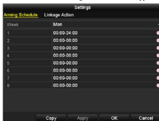
Figure 8. 10 Activeringsschema voor videosignaalverlies instellen
