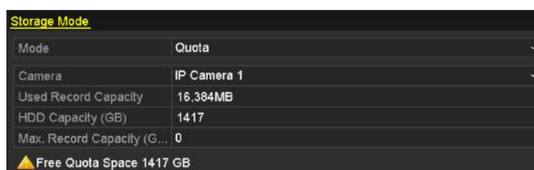
Figure 12. 16 Interface voor opslagmodusinstellingen
