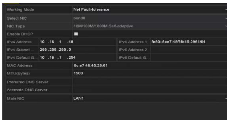
Figure 11. 2 Werkmodus voor netwerkfouttolerantie
