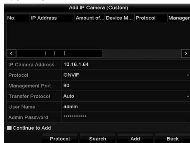
Figure 2. 22 Interface voor het aangepast toevoegen van IP-camera's
