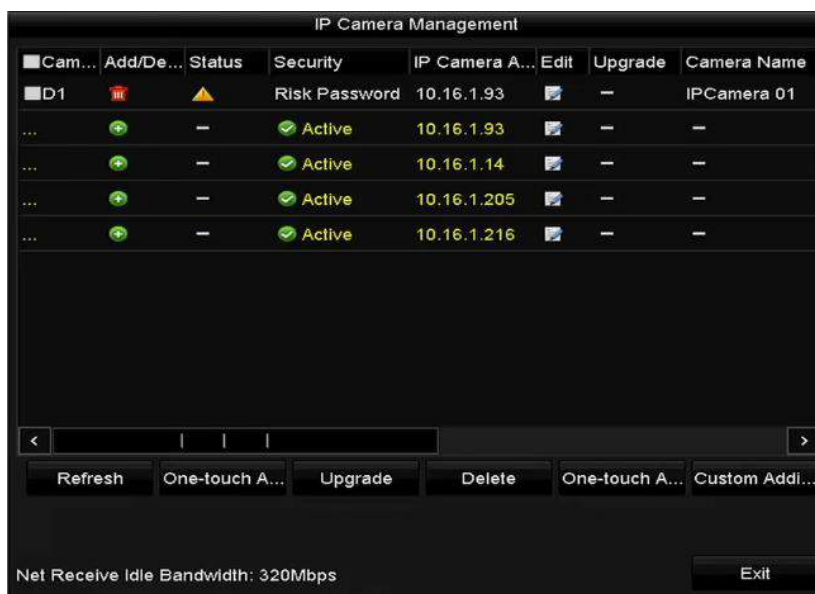
Figure 2. 20 Interface voor het toevoegen van IP-camera's
